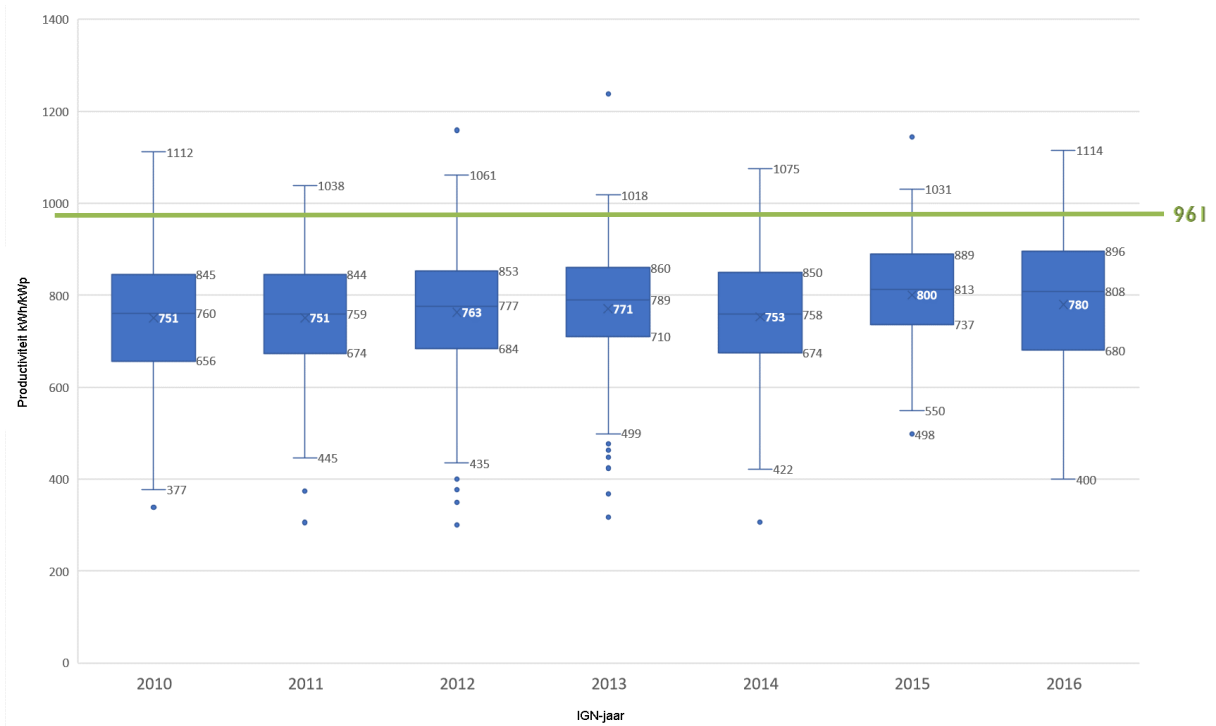
Figuur 34: Genormaliseerde productiviteit van de FV-installaties in het BHG in 2017 uitgesplitst per jaar van ingebruikname. De referentieproductiviteit wordt aangegeven door de groene balk (961 voor het jaar 2017).
