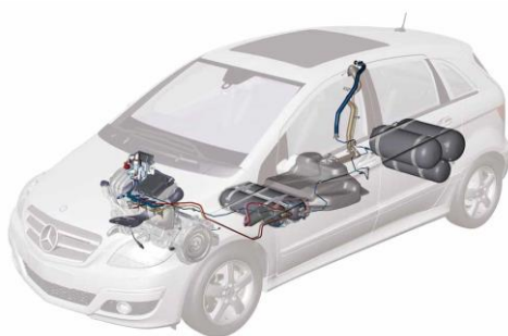
Figure 12 – Système de bicarburation à installer dans le cadre d'une conversion
