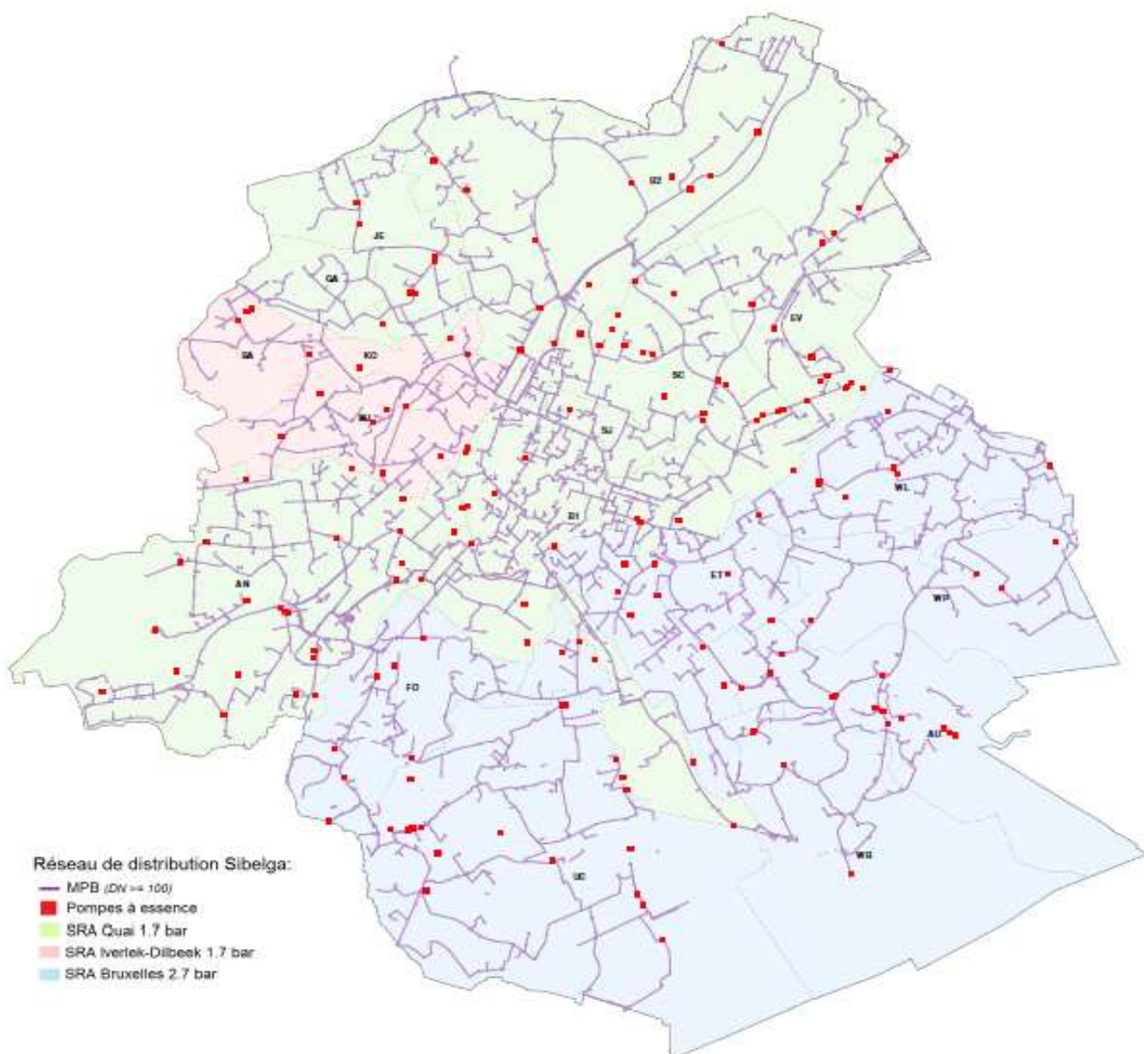
Figuur 3: Plaatsing van de geolocatie van de bestaande stations op die van de DN>DN100-leidingen
