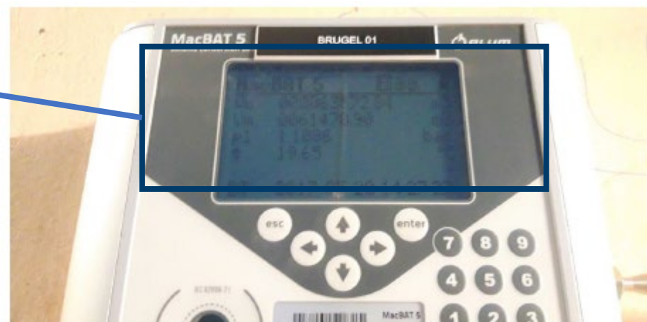
index van gemeten gasvolume, gecorrigeerd gasvolume, gasdruk en gastemperatuur
