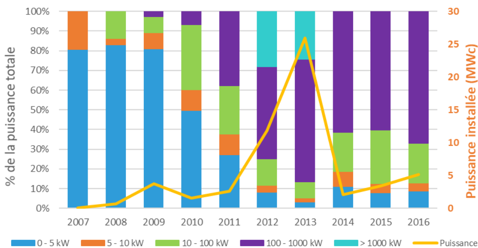
Figure 8 : Evolutions de la part de la puissance totale et de la puissance totale des installations du parc PV en RBC par classe de puissance entre 2007 et 2016
