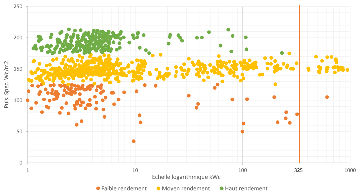
Figure 14 : Puissance spécifique [Wc/m 2 ] et puissance installée (kWc) des installations du parc PV en RBC fin 2016 avec distinction colorées des classes de rendement.
